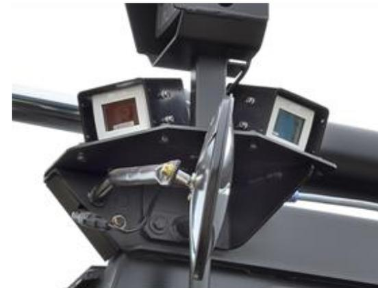
Das System kann pro Kamera Personen im Bereich von bis zu 15m detektieren.
